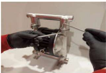
Шаг 1 Снимите выпускной коллектор, раскрутив винты в конструкции X
