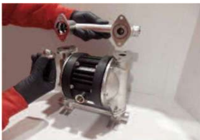
Шаг 2 Удалите шары и опоры. Переверните насос, и отсоедините всасывающий коллектор тем же способом
