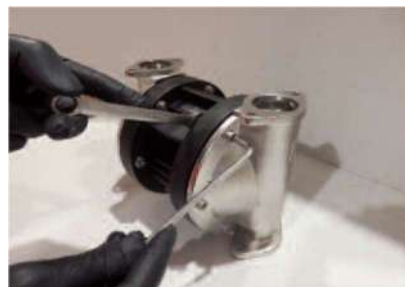
Шаг 3 Высвободите один из двух корпус насоса, раскручивая винты постепенно и циклически
