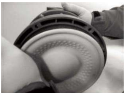
Шаг 4 Разъедините диафрагму от центрального блока и отцепите её левым вращением
