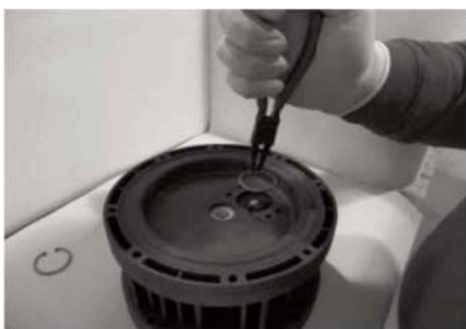
Шаг 1 – Шаг 2 Снимаем предохранители (шаг 1) и вытаскиваем с одной стороны воздушный клапан в сторону внешней части (шаг 2)
