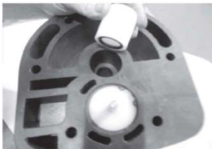
Шаг 1 Установить подшипники внутри центрального блока
