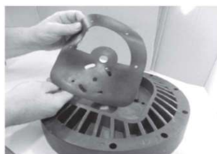
Шаг 3 Установить фланцы в воздушные камеры
