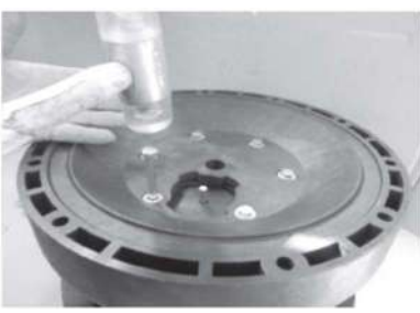
Шаг 5 Зафиксировать винтами
