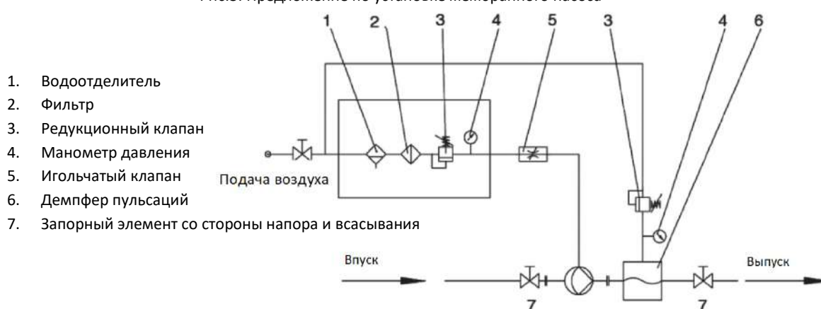
Рис.3: Предложение по установке мембранного насоса
