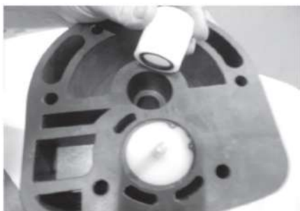
Шаг 1 Установить подшипники внутри центрального блока
