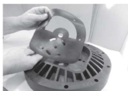
Шаг 3 Установить фланцы в воздушные камеры
