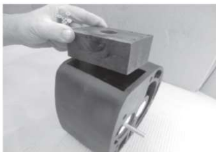
Шаг 2 На центральный блок установить и закрутить крышку выпуска воздуха
