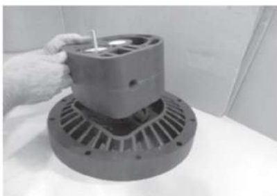
Шаг 4 Скрепить центральный блок с воздушными камерами
