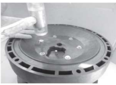
Шаг 5 Зафиксировать винтами
