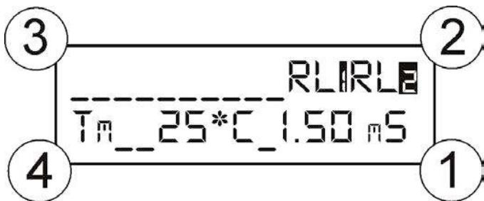
Зона 1 = Дисплей измерений химической проводимости
