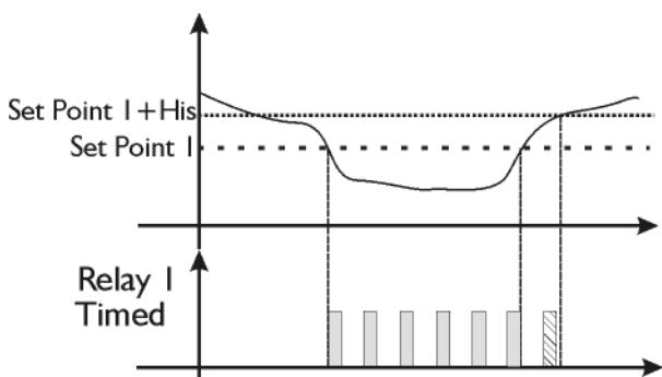
Het instrument start de getimed dosering op bij waarden lager dan 7,20 en beëindigt de dosering bij waarden hoger dan 7,60. De dosering wordt precies andersom verricht als u de Functie Soort dosering in Zuur omzet: de dosering begint bij een waarde hoger dan 7,20 en wordt beëindigt bij een waarde onder 6,80 pH. Het instrument maakt geheel onafhankelijke twee doseringen mogelijk als u het Setpoint 2 behorende bij het relais 2 instelt.
