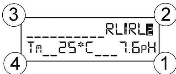
Зона 1 = Дисплей химических измерений pH или Redox.
