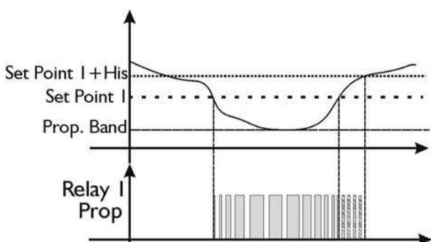
(\* impostando tempi uguali nelle variabili Timer ON e OFF lo strumento calcola un periodo totale che modifica in automatico rispetto alla variazione della misura chimica nella banda di isteresi dosa al valore minimo)
