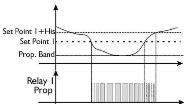
(\* когда для Таймера включения и Таймера выключения заданы одинаковые значения, прибор считает общий период, который автоматически изменяется согласно изменению химических измерений. В зоне гистерезиса дозирование выполняется по минимальному значению)
