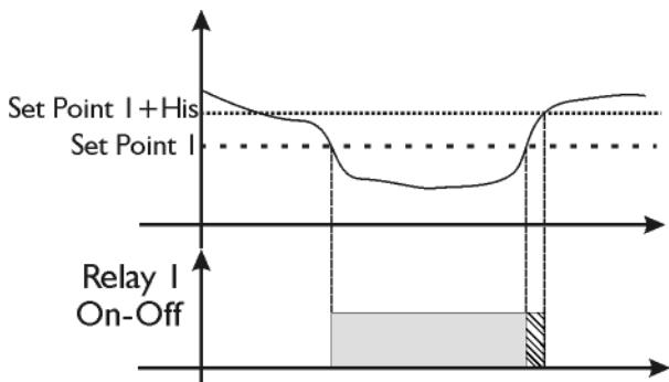
Het instrument start de dosering op bij waarden lager dan 7,20 en beëindigt de dosering bij waarden hoger dan 7,60. De dosering wordt precies andersom verricht als u de Functie Soort dosering in Zuur omzet: de dosering begint bij een waarde hoger dan 7,20 en wordt beëindigt bij een waarde onder 6,80 pH. Het instrument maakt geheel onafhankelijke twee doseringen mogelijk als u het Setpoint 2 behorende bij het relais 2 instelt.
