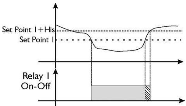
Lo strumento inizierà il dosaggio per valori inferiori di 1,50 mS e terminerà il dosaggio per valore superiore a 1,70 mS; modificando la Voce Tipo di dosaggio con Alto (High) il dosaggio sarà esattamente opposto, inizierà il dosaggio superato 1,50 mS e terminerà per un valore inferiore a 1,30 mS. Lo strumento consente di eseguire due dosaggi in modo indipendente impostando il Set point 2 a cui è associato il relè 2.
