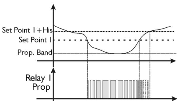
Het instrument start de proportionele dosering op bij waarden lager dan 7,20 en beëindigt de dosering bij waarden hoger dan 7,60. De dosering wordt precies andersom verricht als u de Functie Soort dosering in Zuur omzet: de dosering begint bij een waarde hoger dan 7,20 en wordt beëindigt bij een waarde onder 6,80 pH. Het instrument maakt geheel onafhankelijke twee doseringen mogelijk als u het Setpoint 2 behorende bij het relais 2 instelt.
