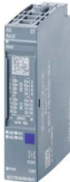
SIMATIC ET 200SP, analoges Ausgangsmodul, AQ 4XU/I Standard, passend für BU-Typ A0, A1, Farocode CC00, Modul-Diagnose, 16 Bit, +/-0,3%
