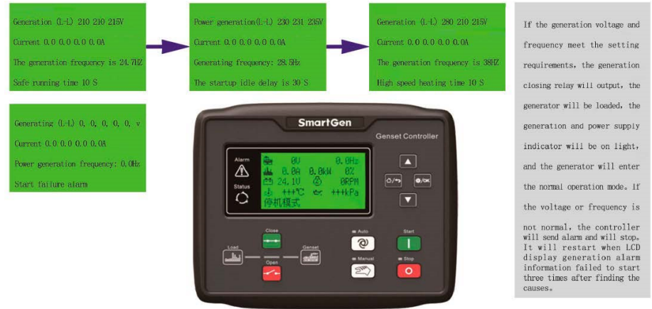
Нормальная работа генератора
